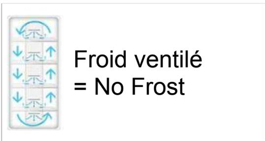
Un ventilateur crée en permanence un mouvement de convection forcé.
