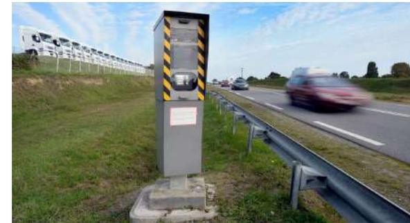
Le temps ( $t_{\text{echo}}$ ) entre l'émission d'une onde et le retour de l'onde réfléchie donne la distance de l'objet.
