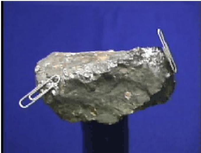
**Minerai de magnétite (alliage de Fer :  $\text{Fe}_3\text{O}_4$ )
