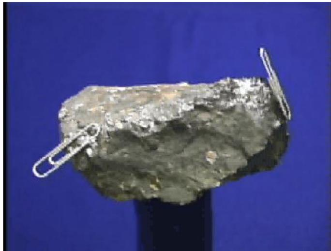
Minerai de magnétite (alliage de Fer:  $Fe_3O_4$ )
