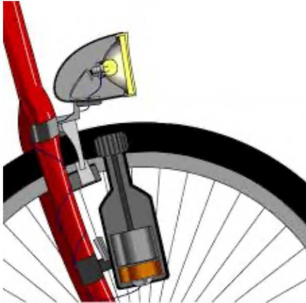
**La dynamo de vélo => courant électrique alimenté par la roue qui tourne
