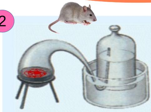
Le mercure se recouvre d'une couche rouge. Le volume d'air a diminué sous la cloche.
