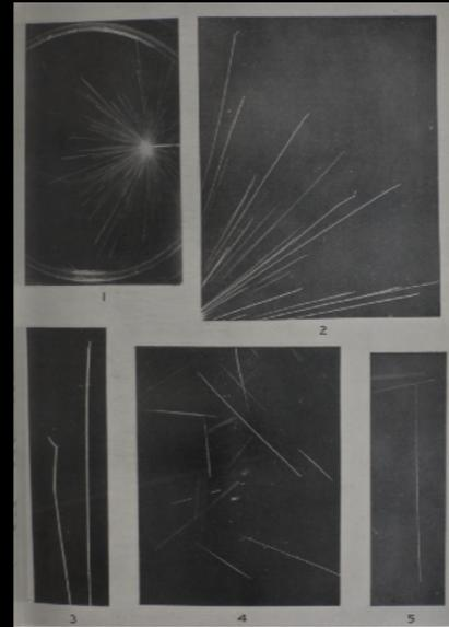
Et voilà le travail. Il ne reste plus qu'à photographier au moment de la détente par le dessus de la chambre pour voir apparaître des traces dues au passage de particules dans la chambre à brouillard.
