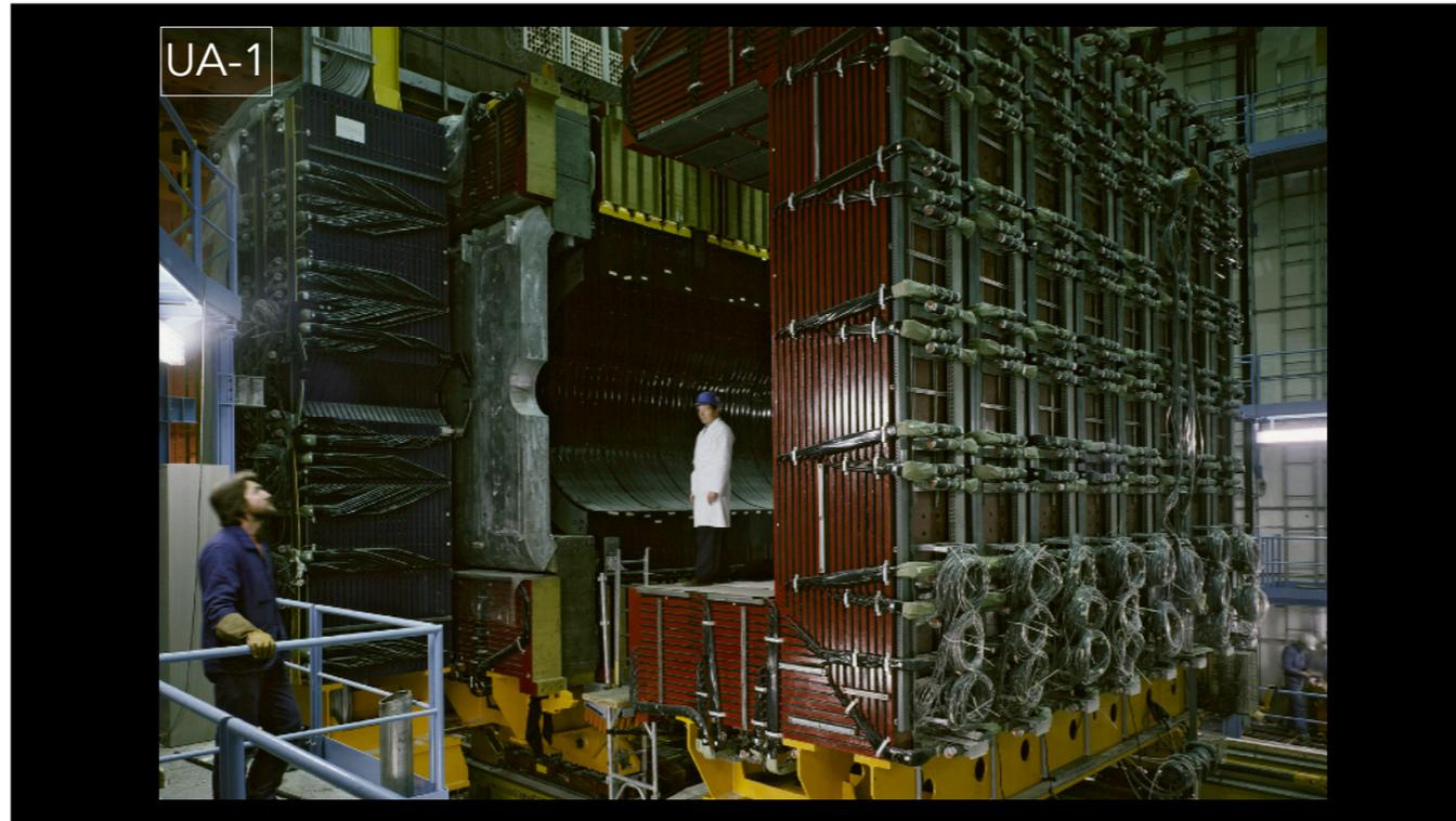
UA1 est conçu pour détecter et identifier de nombreux types de particules émises lors de la collision d'un proton et d'un anti-proton dans toutes les directions.
