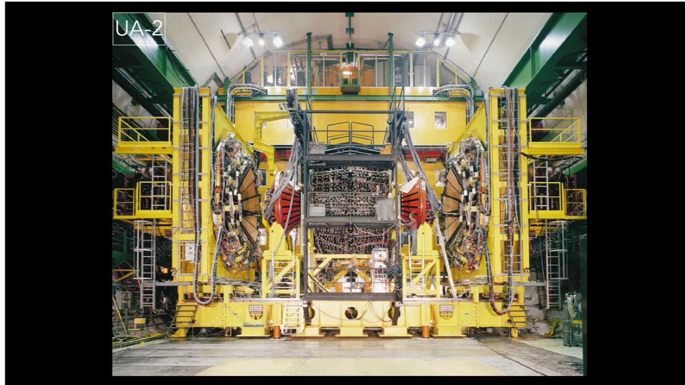
En comparaison, UA-2 fait figure de nain (200 tonnes) et ne rassemble qu'une cinquantaine de physiciens de 6 instituts. Son objectif est plus précisément ciblé : détecter les électrons et des positons issus de la désintégration des bosons.
