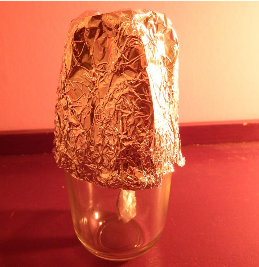
Le métal entourant l'électroscope constitue ce que l'on appelle un écran électrostatique, ou Cage de Faraday. Les charges extérieures sont sans action sur l'électroscope. Les charges restent sur la surface métallique extérieure. Plus exactement, le charge électrique externe provoque le mouvement de charges électriques dans le conducteur métallique qui va induire un champ électrique qui va compenser le champ externe : il va compenser (en partie ou totalement) le champ électrique externe.
